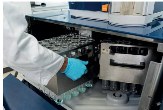
L'analyseur Kjeltec™ 9 est une unité de distillation entièrement automatisée intégrant la phase de titration. Bénéficiez de fonctionnalités innovantes pour des délais d'exécution rapides, une meilleure gestion des données et des résultats précis en réduisant les risques d'erreurs.
